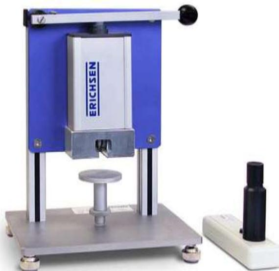
PAINTXPLORER 548 con supporto di foratura e microscopio di misura
