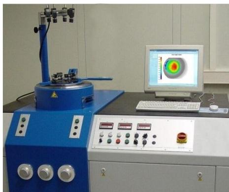
L'AutoGrid® in linea è stato progettato per soddisfare le esigenze dei nostri clienti in termini di flessibilità nel set-up ottico, volume di misura, e risoluzione locale. La misura diretta, veloce e precisa si basa sulla valutazione automatica di modelli di griglia che sono o stampati o elettrochimicamente incisi. Il sistema è in grado di determinare inequivocabilmente un campo di valori di deformazione fino al 100%.
