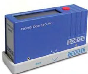
applicazioni. Il PICOGLOSS 560 MC è munito di una calibrazione automatica interna effettuata su di uno standard fornito con lo strumento stesso. Ha una porta USB per poter trasferire le misure su PC. È alimentato da una batteria ministilo da 1,5 volt che gli offre un'autonomia di 10.000 letture. Scale di misura: 0-150 o 150-1.000 unità gloss.
